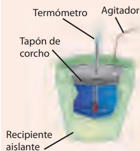
Un calorímetro es un ejemplo de sistema aislado (no hay intercambio de materia ni de energía)
