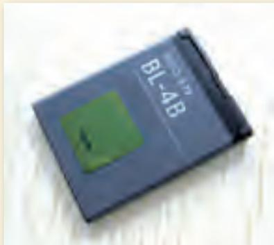
Básicamente están compuestas por un electrodo de grafito y otro de óxido de litio y cobalto ( $\text{LiCoO}_3$ ). Durante la carga los iones de cobalto ( $\text{Co}$ ) se oxidan y los de litio migran al grafito. En cambio, durante la descarga los iones de litio ( $\text{Li}$ ) migran espontáneamente desde el grafito al cátodo.
