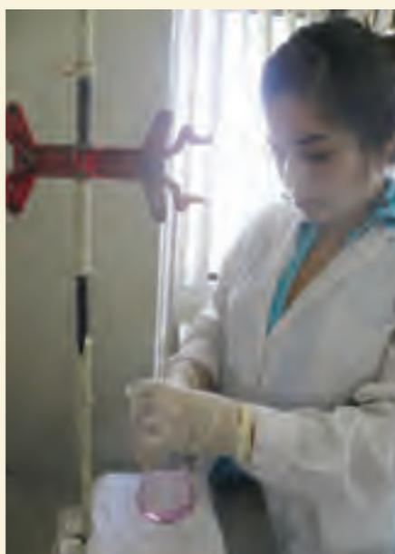
En la bureta se deposita el ácido (HCl), y en el matraz Erlenmeyer, la base (NaOH), junto a unas gotas (2 o 3) del indicador (fenolftaleína).
