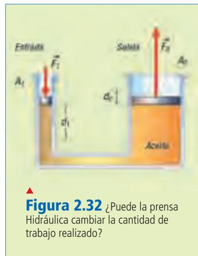
**Figura 2.32** ¿Puede la prensa Hidráulica cambiar la cantidad de trabajo realizado?
