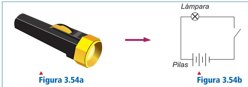
Se compone de una lámpara para producir luz y un interruptor para abrir o cerrar el circuito y las pilas. A estos les llamaremos elementos del circuito. Simbolizaremos cada componente del circuito eléctrico de la linterna por la **figura 3.54b**.
