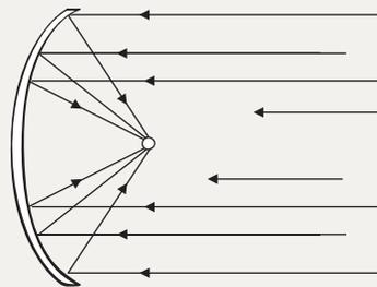
EN UNA ANTENA PARABÓLICA TODAS LAS SEÑALES RECIBIDAS SE CONCENTRAN EN UN PUNTO.
