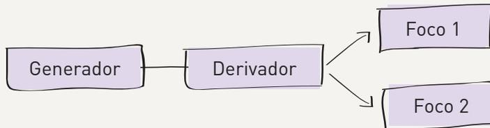
La corriente parte desde el generador hasta el derivador, que funciona aleatoriamente. Cuando un foco no funciona, implica que la torre que los contiene quedará apagada. Mario lleva un registro de las fallas y estima que:
