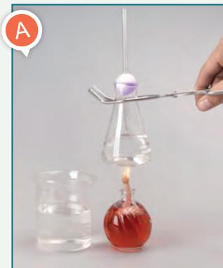
◀ Puso 5 mL de disolución de amoníaco en un matraz y le ajustó un tapón al que adaptó un tubo de vidrio. Luego, calentó el amoníaco hasta que comenzó a observar que el vapor de amoníaco ascendía por el tubo de vidrio.
