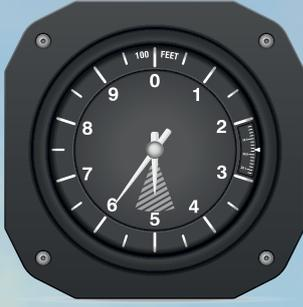
Instrumento de medición que indica la diferencia de altitud entre el punto donde se encuentra localizado y un punto de referencia; habitualmente se utiliza para conocer la altura a la que se encuentra un punto sobre el nivel del mar.
