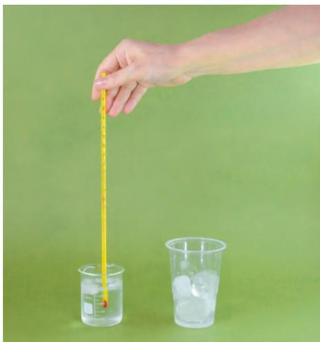
Estas imágenes muestran el montaje del experimento. Recuerda que al medir la temperatura con el termómetro, este no debe tocar las paredes del vaso precipitado.
