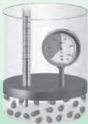
Disminuye la velocidad a la que se mueven las moléculas del gas. Por lo tanto, para mantener la presión, se debe bajar el émbolo, es decir, disminuir el volumen.
